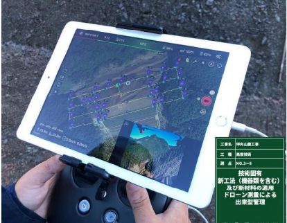
UAVによる起工測量及び出来形管理測量
