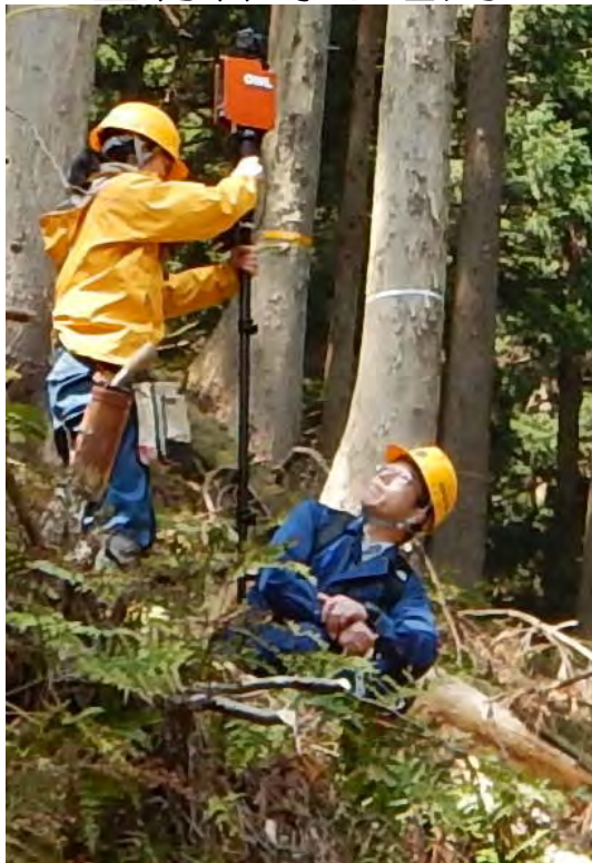
3Dレーザースキャナによる森林調査の試行 (湖北：笹ヶ峰国有林：高島市)
