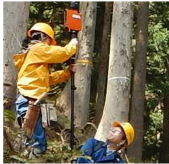
地上レーザ測量
