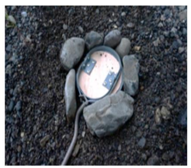
罠の周囲を石で囲むことで罠の中心を踏ませるよう工夫
