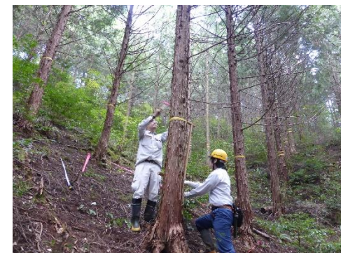
【標準木の応力伝播時間測定装置（FAKOPP）による材質（強度）調査】
