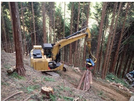
高性能機械による造材 (福山市:新元重山国有林)
