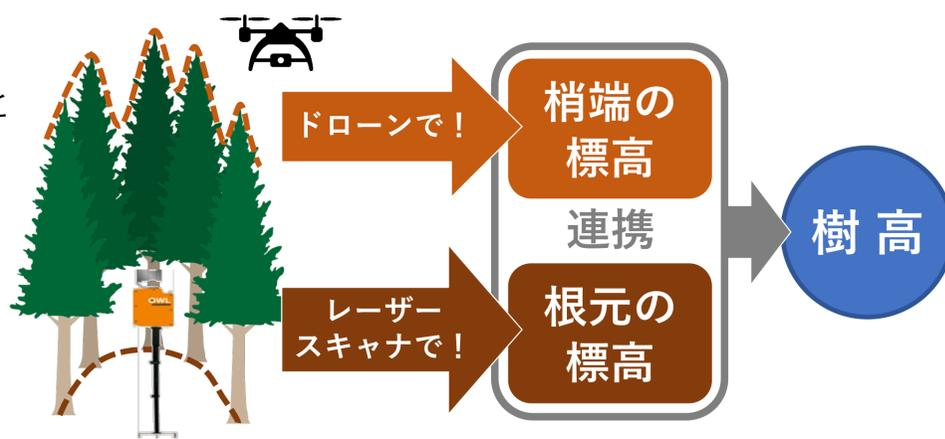
ドローンとレーザースキャナを連携した樹高計測のイメージ
