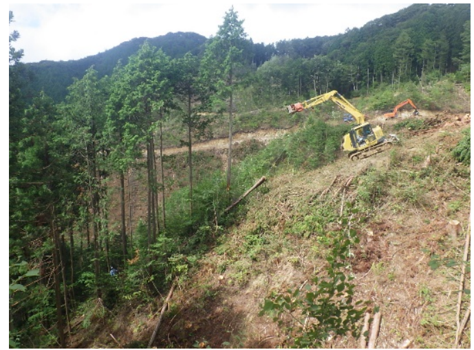
写真2 受光伐区集材状況(スイングヤーダ集材)
