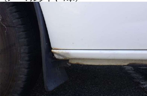
(下部錆・凹み)
