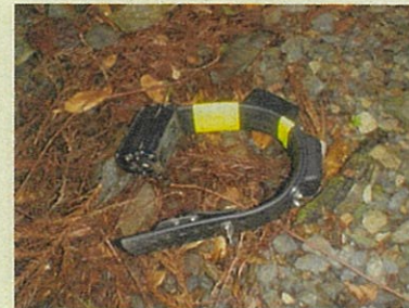
写真 6-7 回収したGPS首輪 (個体 3: 脱落装置が作動していた)
