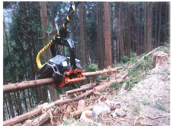
プロセッサーによる造材
