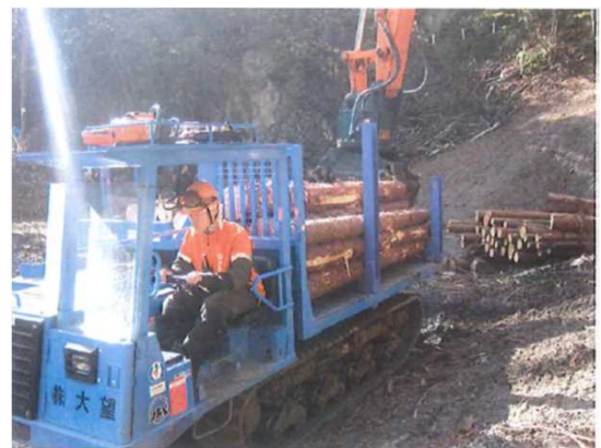
フォワーダーへの積み込み・運搬
