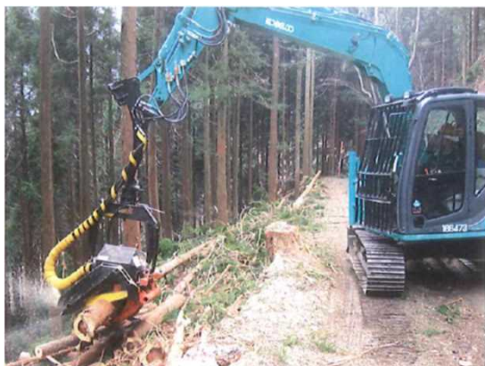
プロセッサーによる造材
