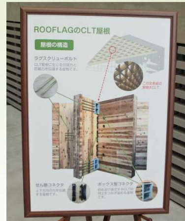
実物大のCLT（交差部）が展示されていて、大きさや厚さ、接合部分に使用されているボルトやボックス型金物などに直接触って体感することができます
