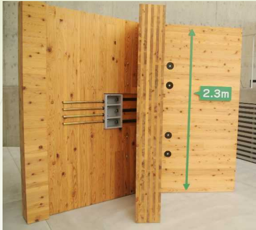
実物大のCLT（交差部）が展示されていて、大きさや厚さ、接合部分に使用されているボルトやボックス型金物などに直接触って体感することができます
