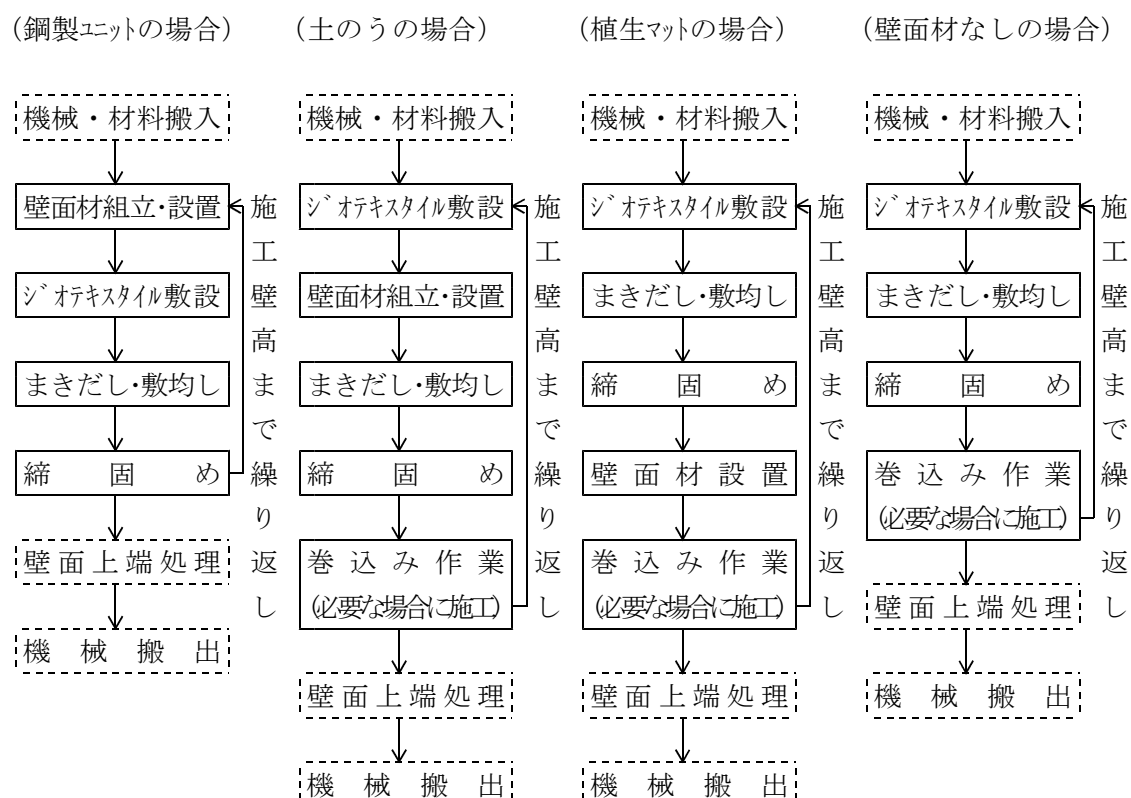
壁面材別施工フロー
