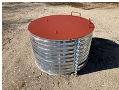
捕獲個体残渣減溶化処理容器 （直径1m 地上0.7m 地下3.3m）
