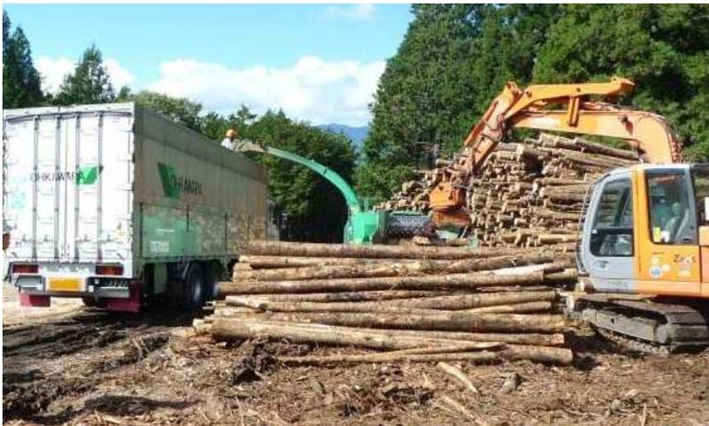
集積場に集まったウラジロモミの丸太は皮付きのまま移動式チップperで破碎、直接トラックの荷台に移され、製紙工場に運ばれていきます。このチップは主にクラフト紙の原料になるそうです。
