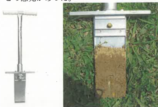
図 3.30 ルートプロファイラーの形状 (左)、抜き取られた土壌の断面 (右)
