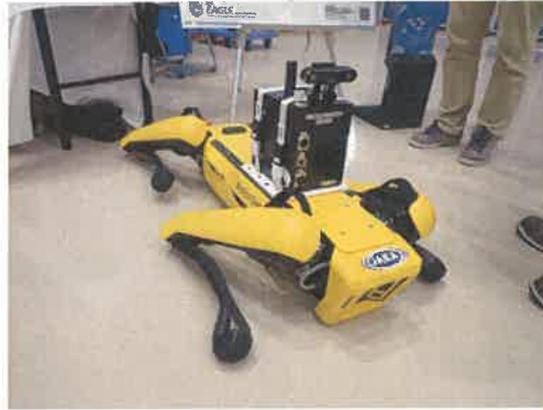
図 3.27 SPOT+自立位置推定型サーベイメータ搭載型モデル
