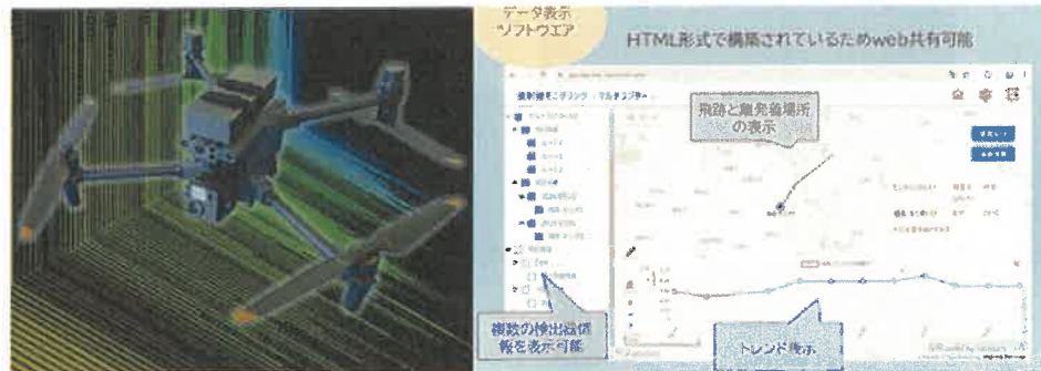
図 3.22 ドローン型モニタリングポストと取得データ例
