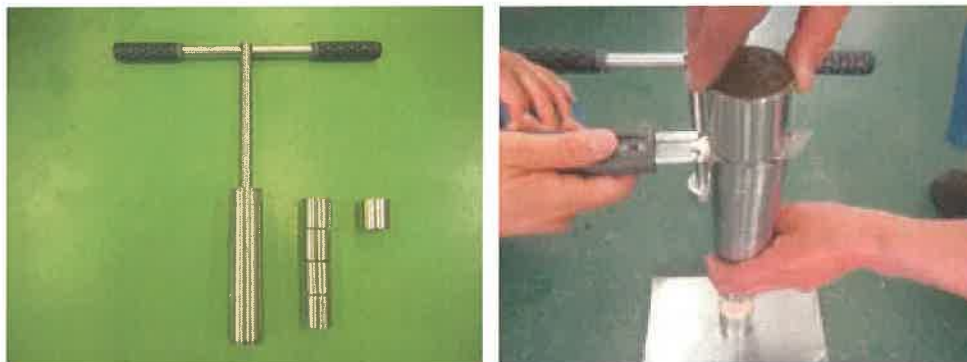
図 3.31 土壌物理測定用コアサンプラー (左)、採取後に切り分けているところ (右) 出典：株式会社藤原製作所 HP https://fujiwara-sc.co.jp/product/agricultural-science/soil-sampler/hsc-20/
