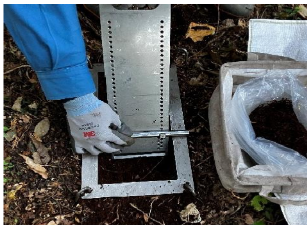
層別試料の採取(スクレーパープレートによる)
