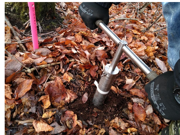
土層の採取(ハンドサンプラーによる)
