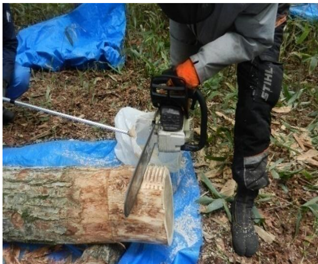
辺材・心材の採取 (おが粉状試料を採取)
