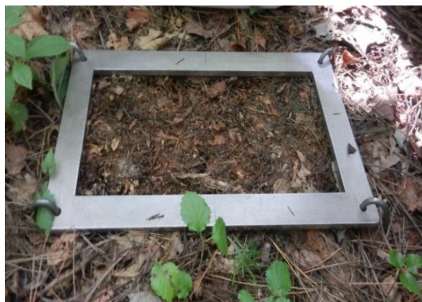
方形枠(スクレーパープレート 天板)の設置
