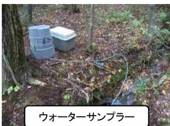
各事業地の溪流等にウォーターサンプラーを設置し、事業期間中(H28.10～H29.2)1日1回採取したサンプル水の濁度を測定。
