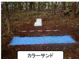
高性能林業機械走行路、走行路斜面にカラーサンドを設置し、土砂の移動量を調査。
