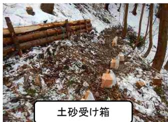
表土流出防止効果を検証するため、各施工箇所の斜面下部に土砂受け箱を設置し、土砂の移動量を調査。
