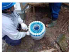
自動ウォーターサンプラー 渓流水の濁度及び放射性物質濃度を測定
