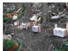
土砂受け箱 斜面の土砂等の移動量を計測
