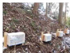
土砂受け箱 斜面の土砂等の移動量を計測
