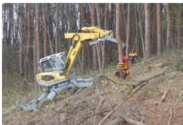
4輪多関節型作業機械による伐採作業（白河支署）
