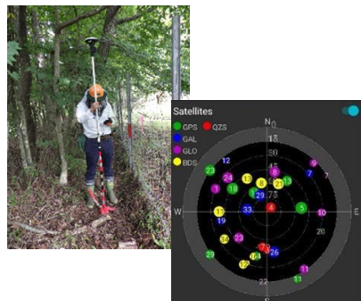
GNSSによる周囲測量の様子と現地データ
