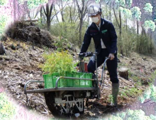
電動苗木運搬車実証試験
