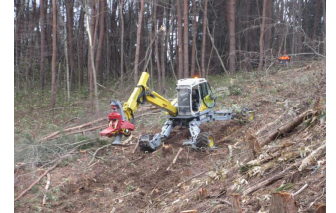
高性能林業機械（四輪多関節型）現地検討会
