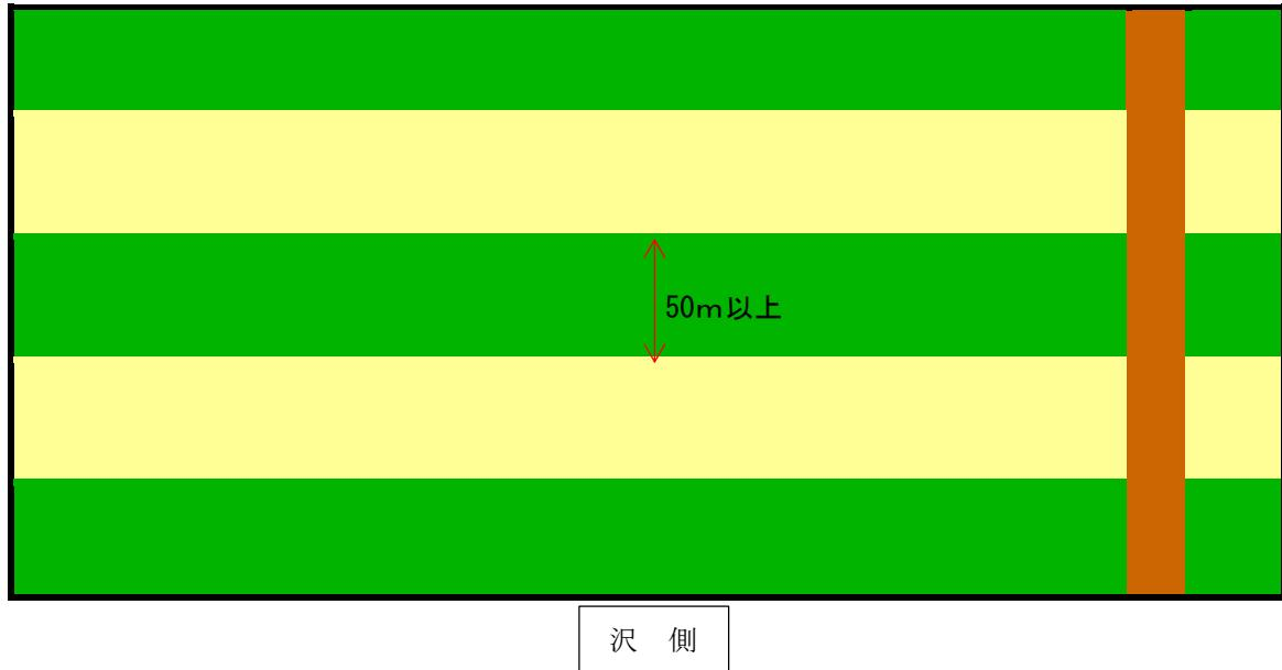
連続した伐採を避けるため、伐採箇所と伐採箇所の間隔は 50m以上確保する。
