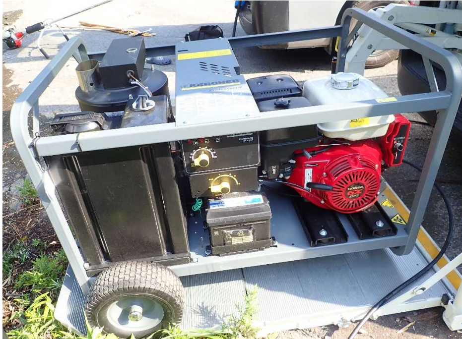
ヒートコイル式ボイラー（瞬間湯沸かし器のような仕組み）
