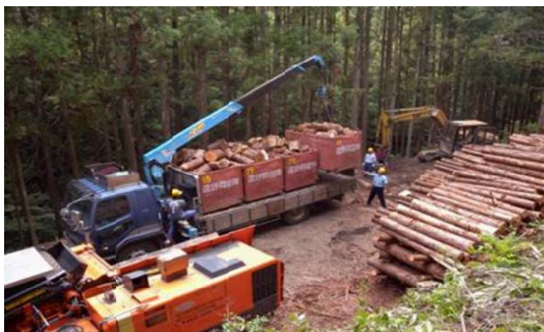
専用コンテナを利用した低質材や林地残材の集荷作業
