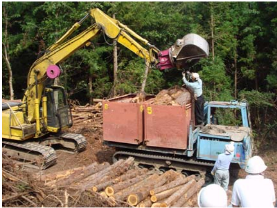
鉄製コンテナを利用した林地残材の集荷
