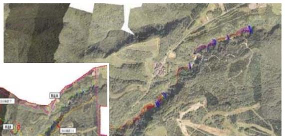
図3 シミュレーションによる土砂の流出と治山施設による捕捉状況
