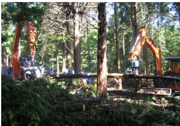
小型グラップルでリレー形式で集材する様子（静岡署）
