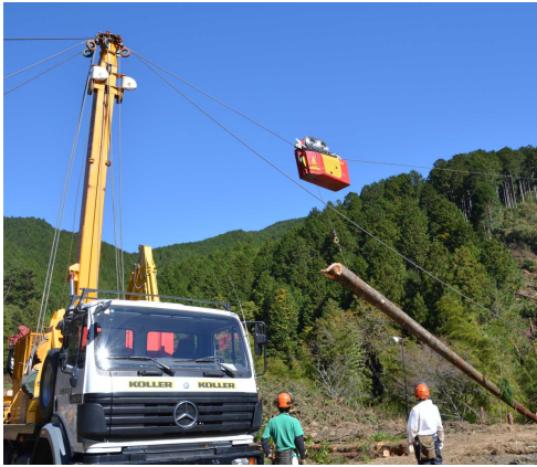
タワーヤード、自走式搬器による搬出
