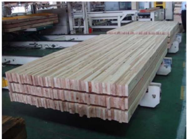
集成材製造の接着工程
