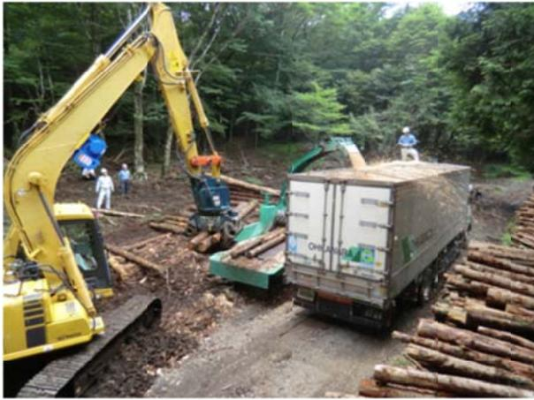
移動式チップパー機によるチップ加工・積込
