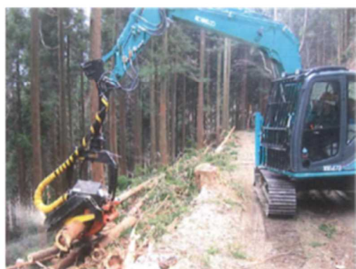
高性能林業機械を使用した丸太の伐り出し
