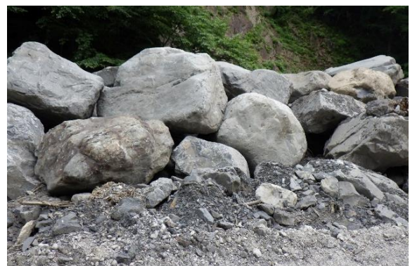
とこぼり 床掘により発生した転石
