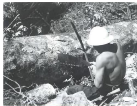
(チェーンソー導入以前の 手工具による伐採、玉切作業)
