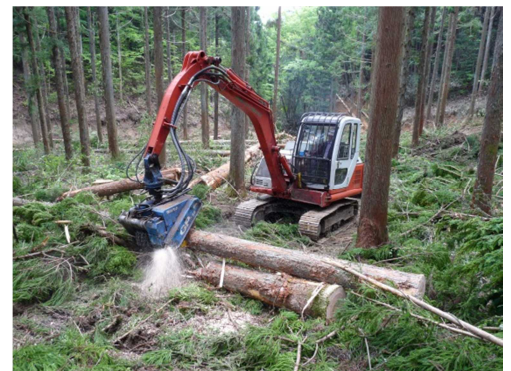
高性能林業機械による造材の様子
