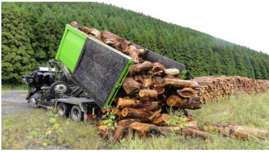
専用運搬車による林地残材搬出
