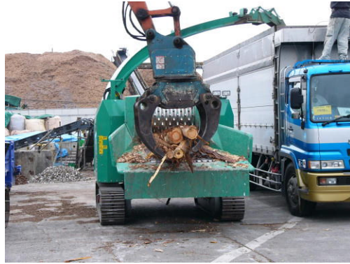
静岡県内製紙工場視察 移動式チップパー（1日当たり100m 3 処理可能）
