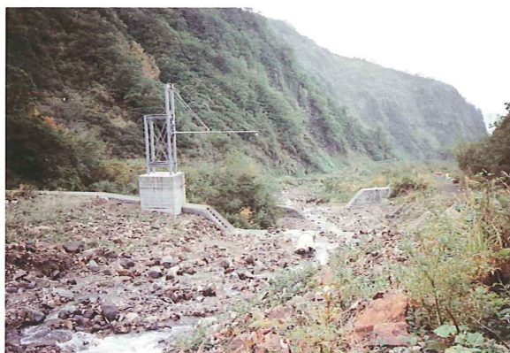
〈焼山川中流部に設置された土石流センサー等〉
