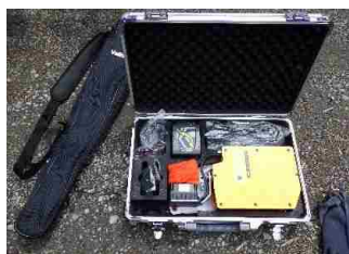
収納されたICT機器（地上型3Dレーザ照射スキャナ）
