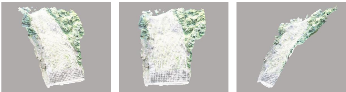
図一 9 治山工事の 3D モデル
