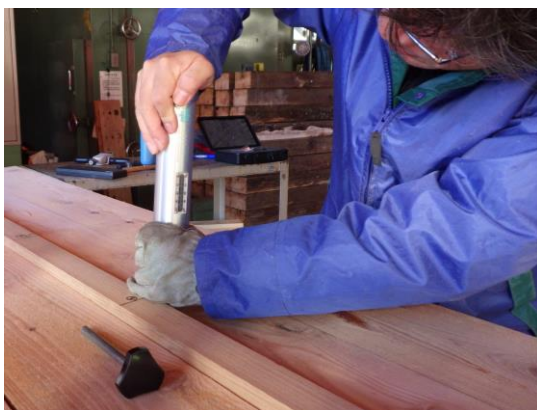
図3 打込み、貫入試験の様子(ピロディン打込み)
