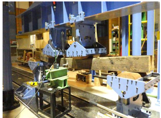
図2 曲げ試験の様子
