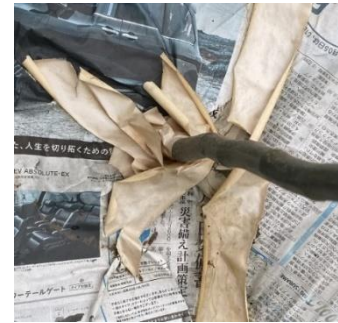
図5(b) ガムテープの劣化
