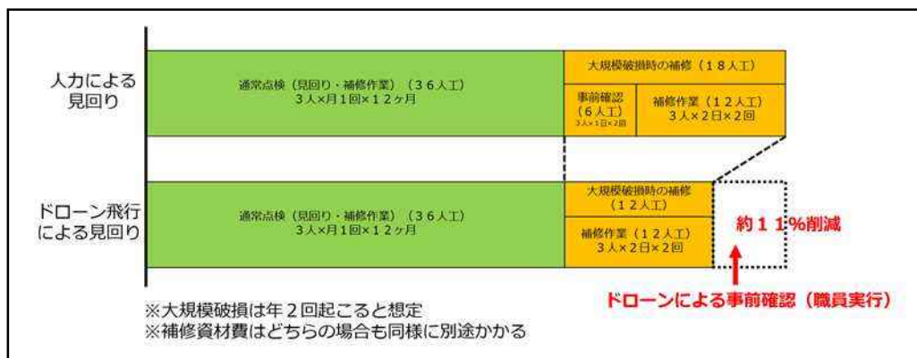
(図-2) 本調査地における見回りにかかる人件費の比較 (1年あたり)
