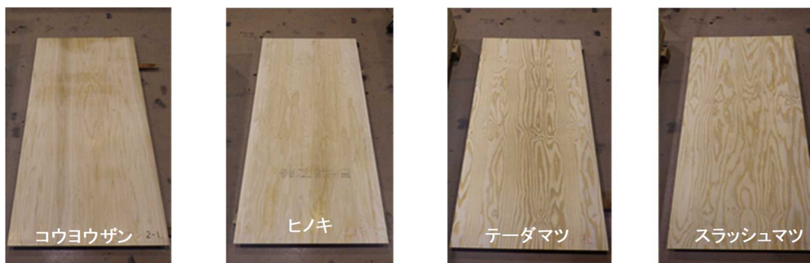
写真 2 試作した早生樹合板
