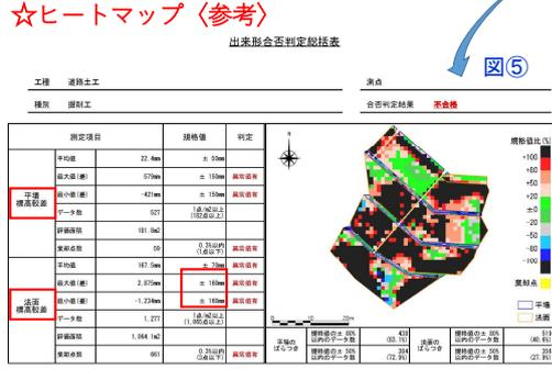
排土工のヒートマップを作製。設計高の規格値の±20%以内が緑色で表示され、誤差に応じて色別に表示され、黒色が設計基準値の±100%を超えている箇所が不合格。
