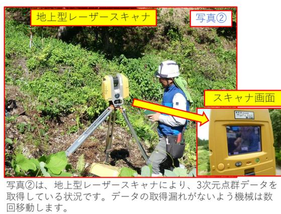
2. 目的 ★当面の目的 起工測量時の3次元点群データと設計データを重ね合わせ、両者の差分から求積した土工数量を変更契約に採用できるようにする。
