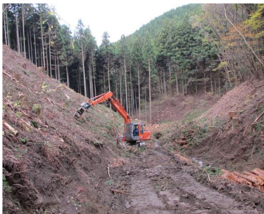
高性能林業機械を活用した地拵作業 (一貫作業システム) (大田原市南方)
