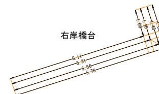
コンクリート数量 :  $(5.31+5.76)/2 \times (1.50 \times 0.2) + (1.20+1.65)/2 \times (1.50 \times 0.2) = 2.09\text{m}^3$
