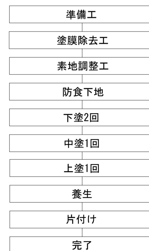
塗替塗装工フロー
