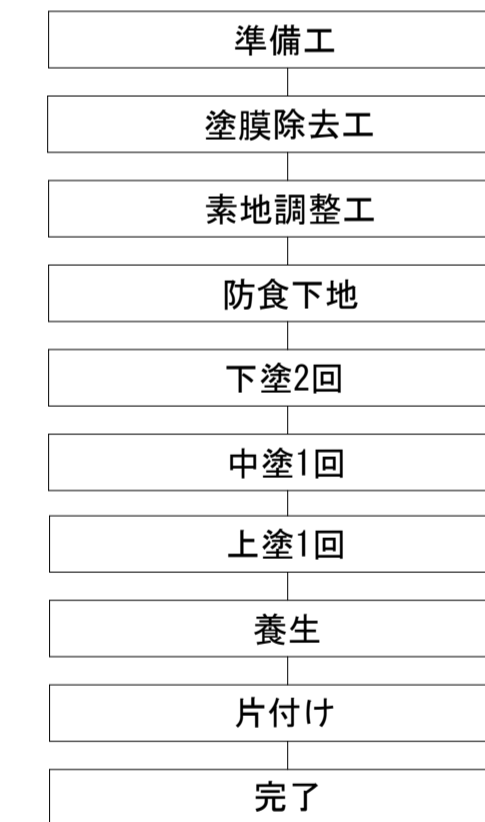
塗替塗装工フロー
