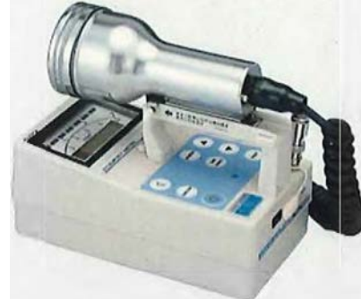
写真1 GM計数管式サーベイメータ 型式：TGS-146B
