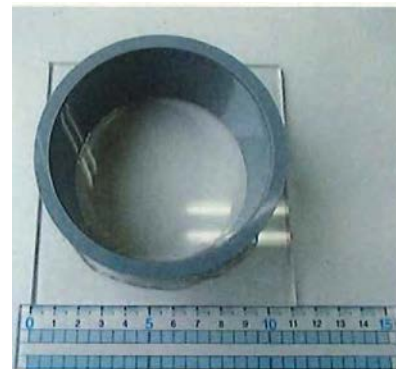
写真2 アクリル板（参考例） 参考例では、塩ビ管を用いた。
