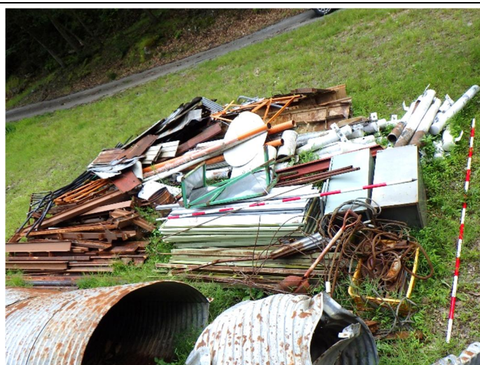
鋼製横断工・車庫鋼材・プレハブ倉庫部材・ガードレール・単管パイプ・トタン板・その他鉄くず
