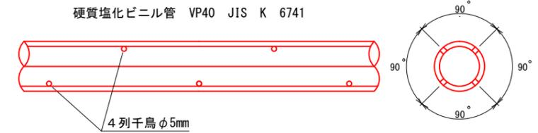
孔口保護工詳細図 S=1/50
