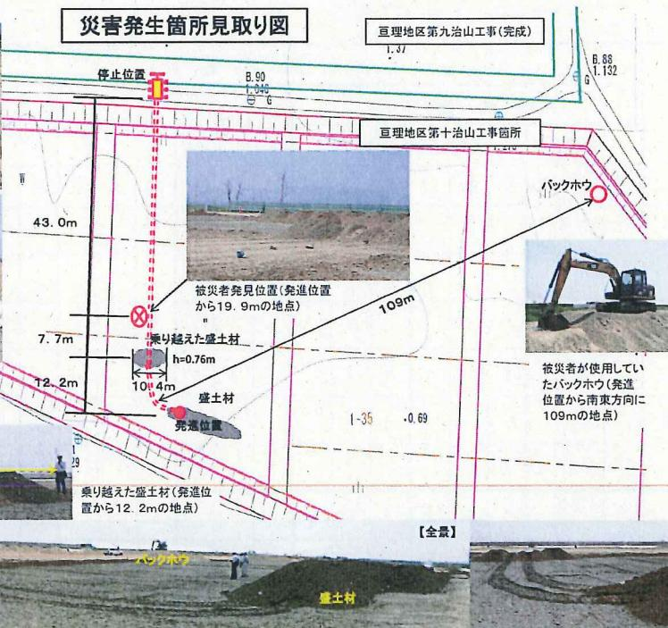
ブルトーザーで敷均し作業に従事していた被災者が、荷卸し状態の盛土材(高さ1m程度)を乗り越えた際の衝撃で、ブルトーザーの左ドアから落下しブルトーザーの左側のキャタピラの下敷きになり受災したものと推定される。(本件は被災者が事業主であるため労働安全衛生法上の労働災害には該当せず労働災害の件数に含まれない)
